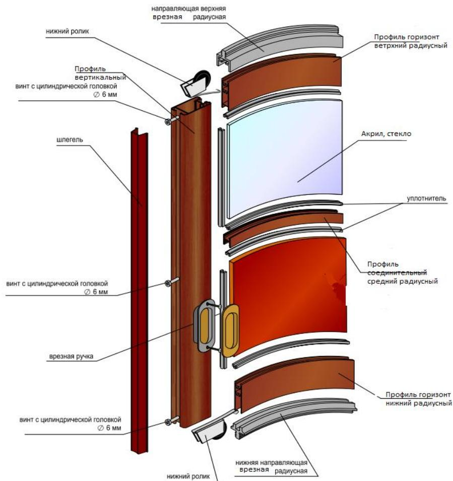
Радиусные двери в шкаф купе устанавливаются на врезные направляющие, используется нижний ролик как сверху, так и внизу. Стопор ставится в верхнюю направляющую. Вверху направляющие закрываются фризом/карнизом.
